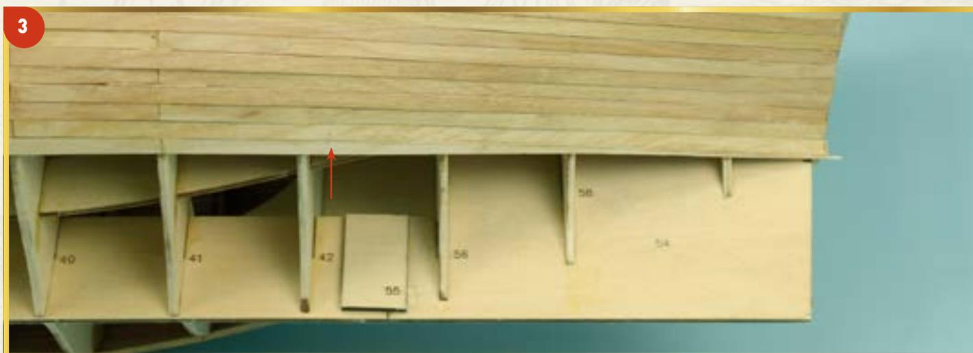
**3** Приклейте вторую планку к задней части каркаса, продолжая текущий ряд (предварительно заузьте ее задний конец так, как показано на фотографии).
