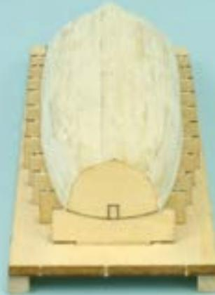
**1** Мы продолжаем работу над обшивкой каркаса шлюпки, которую мы начали на предыдущем этапе. Обшейте планками сечением 0,5 x 3 мм правый борт шлюпки, руководствуясь инструкциями этапа 47.
