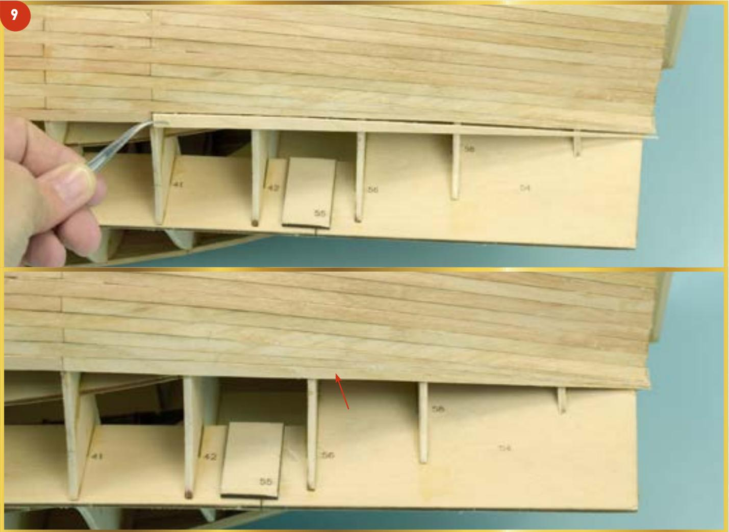
**9** Завершите ряд обшивки, который вы начали в шагах 7–8, приклеив к кормовой части каркаса последнюю планку, зауженную так, как показано на фотографии.
