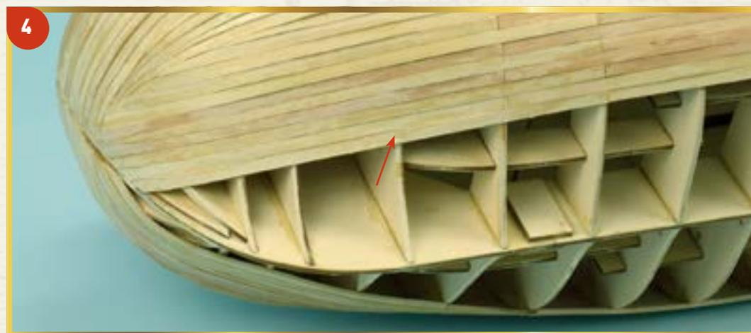
**4** Завершите этот ряд, приклеив еще одну планку к носовой части каркаса. Данную планку также нужно обрезать и обработать, чтобы она в точности соответствовала изгибам корпуса.
